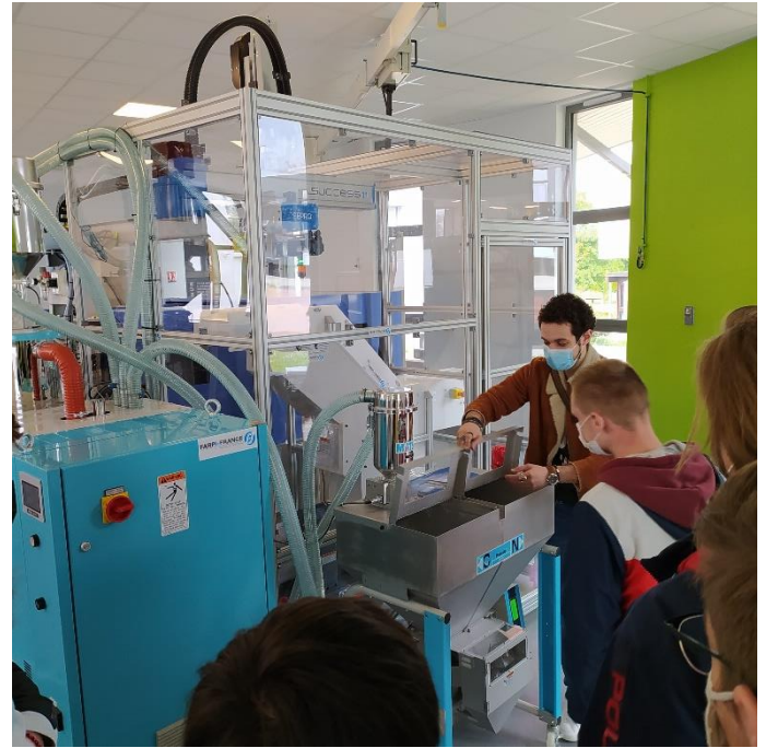
Dispositif d'intégration/dosage automatique de matière plastique recyclée à un cycle de production
